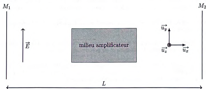
Figure 1 – Schéma simplifié d'un milieu amplificateur à l'intérieur d'une cavité linéaire délimitée par deux miroirs M_1 et M_2 .
